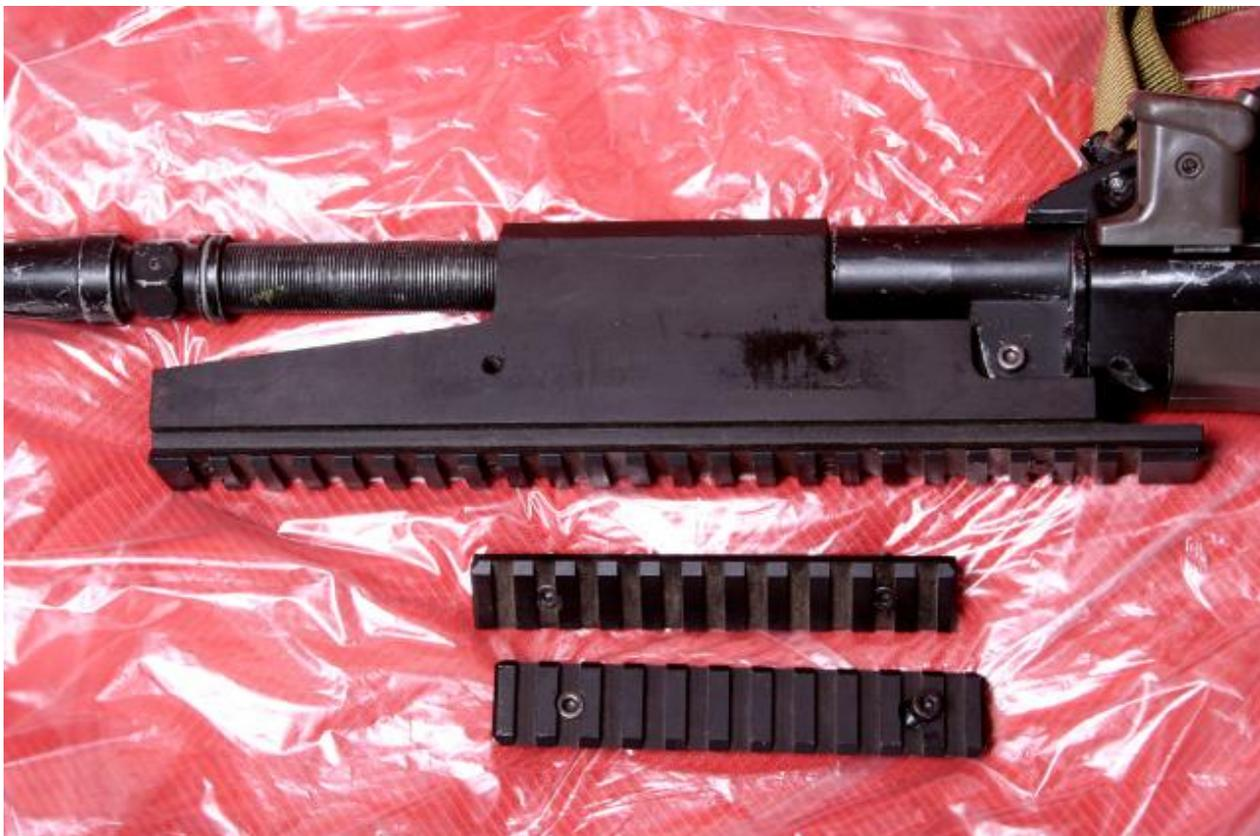
Автор-изготовитель сделал две дополнительные планки Пикатинни съемными, каждая из которых фиксируется двумя шестигранниками. Рекомендуется их снять сразу же, т.к. они добавляют лишний вес, при этом не неся особой функциональности. Сам крепеж надевается на ствол, после чего фиксируется шестигранником и дополнительной накидной гайкой на стволе (на снимке отсутствует).
